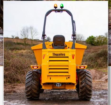
El dumper de fase V con tolva giratoria de 9 toneladas de Thwaites se ha fabricado pensando en los contratistas y arrendatarios, para garantizar la seguridad del operario, reducir el riesgo en la zona de trabajo y mejorar el rendimiento. El volquete giratorio permite una rotación de 90° a izquierda y derecha para mejorar el acceso de la máquina a las cargas de volcado en áreas restringidas, gracias a lo cual el operario dispone de mayor control y se reduce el riesgo en la zona de trabajo.
